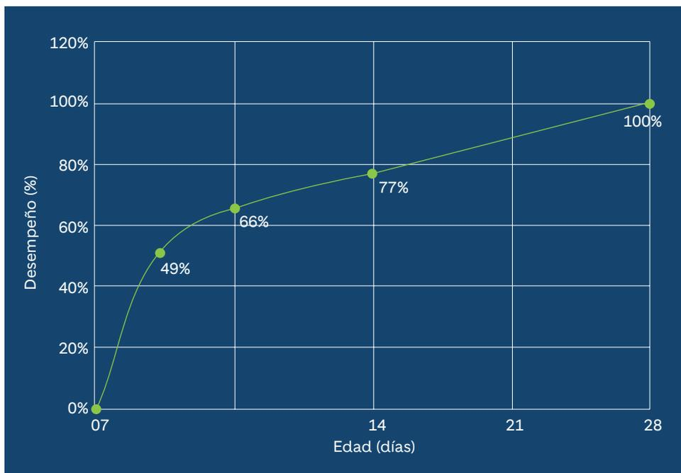
Evolución mínima esperada de resistencia a compresión, de muestras tomadas en obra. Aplican condiciones y restricciones.
