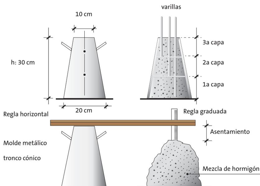
Ensayo de asentamiento con cono Abrams.
